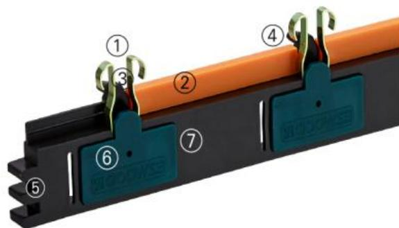
①快速夹具头: DECK材料固定 ②防震橡胶: 吸收冲击及防止噪音 ③快速夹具槽: 缓解收缩膨胀 ④快速夹具水平旋转: 快速夹具水平材料 ⑤快速夹具连接部: 快速夹具连续连接接头 ⑥快速夹具固定用槽: 快速夹具固定槽 ⑦快速夹具模块: 主体
