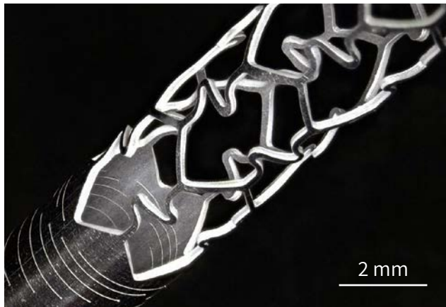
激光切割支架。 样品源自：Amada Miyachi America.
